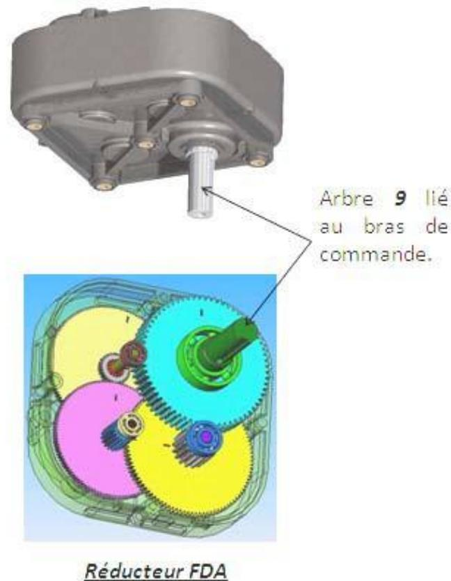
Le moteur **21** (3000 tr /min) entraîne le pignon moteur **19** qui, par les différents trains d'engrenages du réducteur **19-5** ( $m=0,75$ ), **3-22** ( $m=0,75$ ), **23-17** ( $m=1$ ) et **16-11** ( $m=1,5$ ), transmet le mouvement à l'arbre **9** (lié au bras de commande) qui pivote de  $90^\circ$  pour permettre l'ouverture ou la fermeture complète du vantail.
