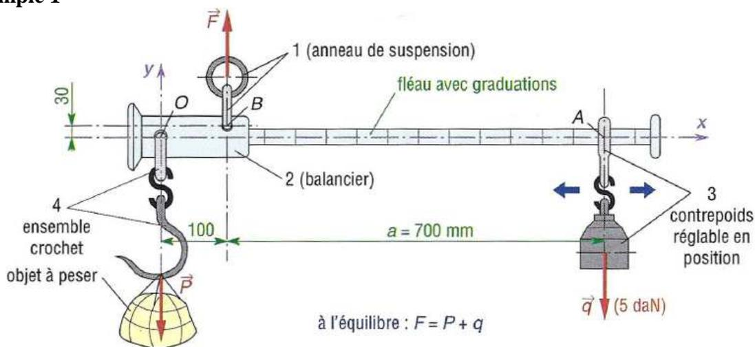
Une balance romaine se compose d'un balancier **2**, avec fléau gradué, articulé en **B** (pivot) sur un anneau de suspension **1** lié à un support fixe et d'un contrepoids d'équilibrage **3** réglable le long du fléau (a variable) de poids **q** (5 daN). La masse à peser **P** est suspendue en **O** (pivot) par l'intermédiaire d'un crochet **4**.
