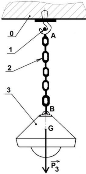
La lampe suspendue représentée ci-contre se compose d'un abat-jour 3 maintenu en B par la chaînette 2. L'ensemble est accroché en A sur le crochet 1 lui-même encastré dans le plafond 0.
