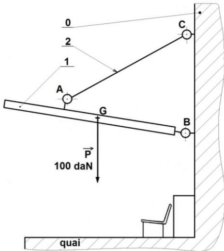
L'abri de gare représenté ci-contre se compose d'une partie toiture 1 articulée en B sur le mur 0 de la station, et d'un tirant 2 assurant l'équilibre de l'ensemble.
